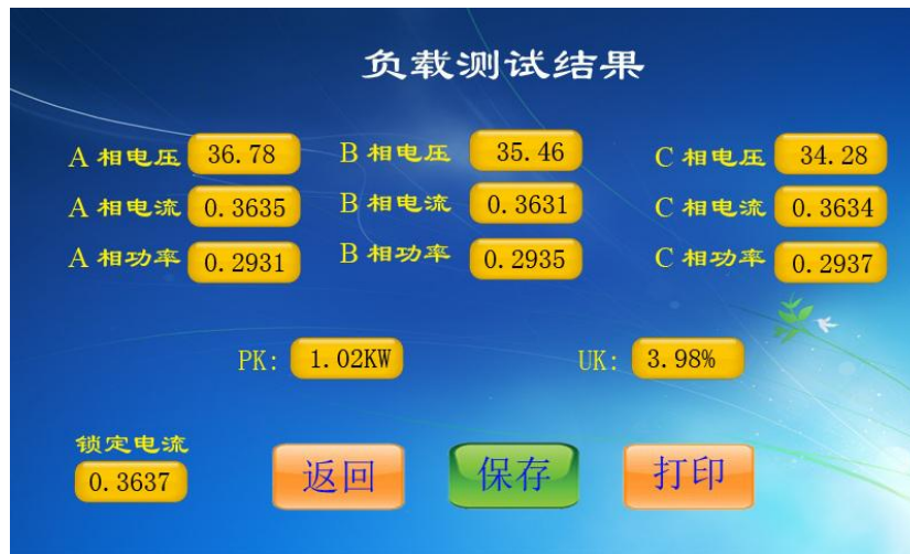
图 9 三相负载测试结果
