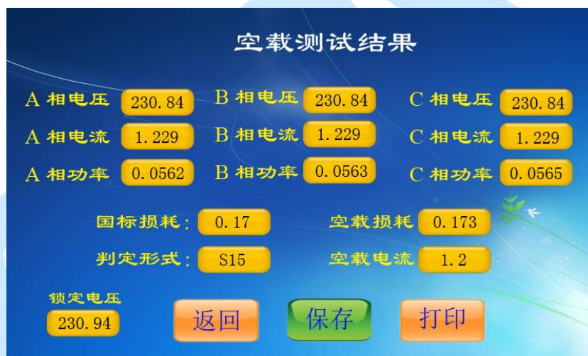
图 12 三相空载测试结果
