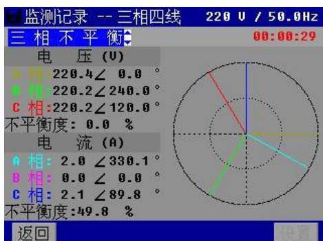
图 4-36 监测记录电压/电流不平衡
