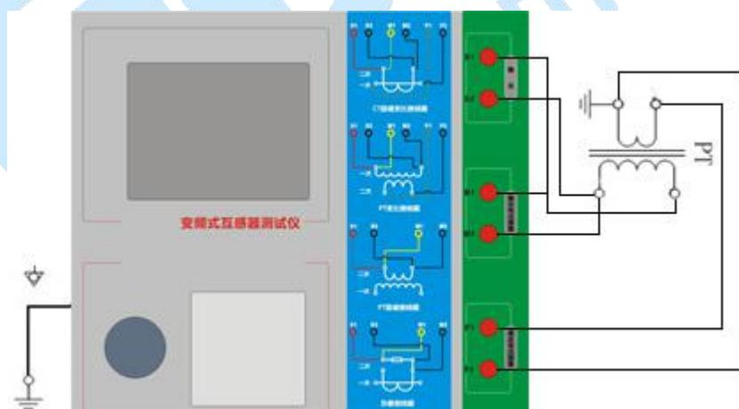
图 6 PT 变比、极性试验接线方式
