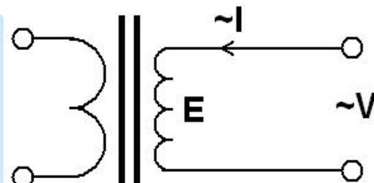
由公式中可见在某一激磁电感  $L$  时所加电压  $V$  与频率  $f$  成正比关系。
