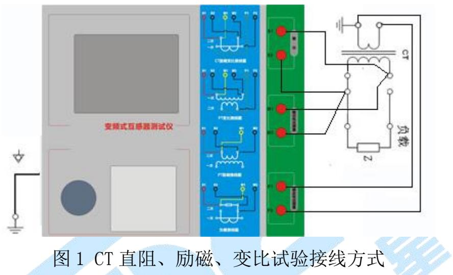
图 1 CT 直阻、励磁、变比试验接线方式
