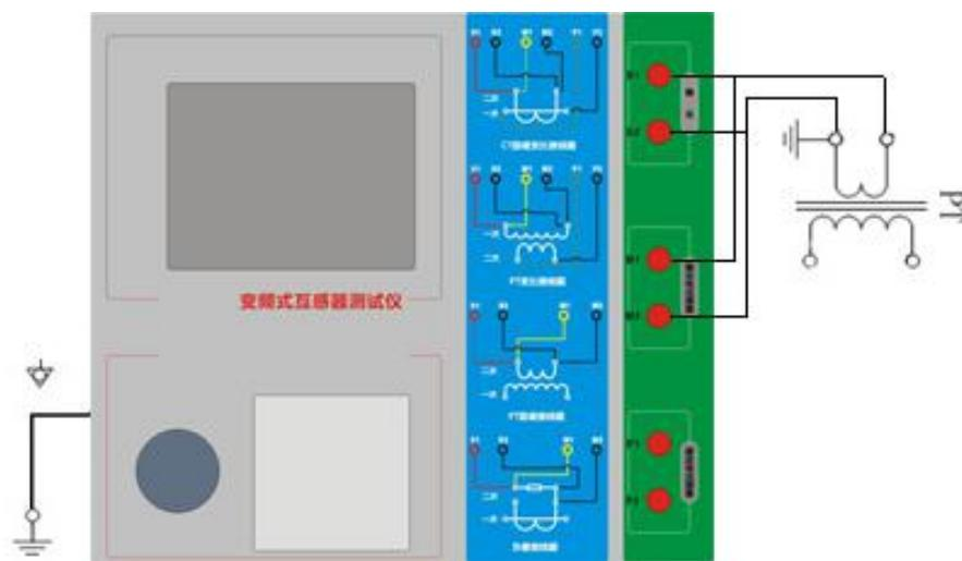
图 5 PT 直阻、励磁试验接线方式
