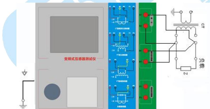
图 2 CT 二次负荷试验接线方式
