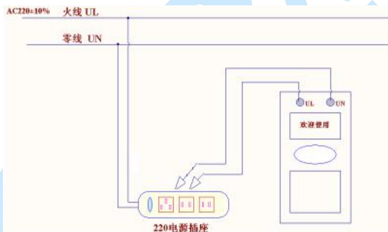
图 8 分机现场接线示意图
