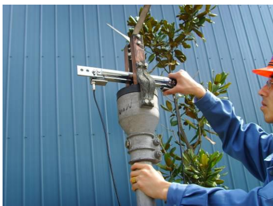
第三步 测量触指压力
