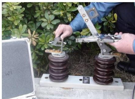
第一步 测量触头的宽度 a
