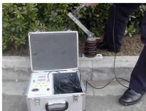
第三步 测量触指压力
