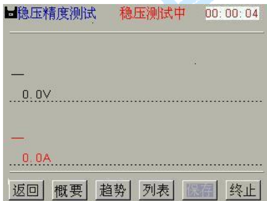
图 4-2-5 稳压精度测量趋势显示
