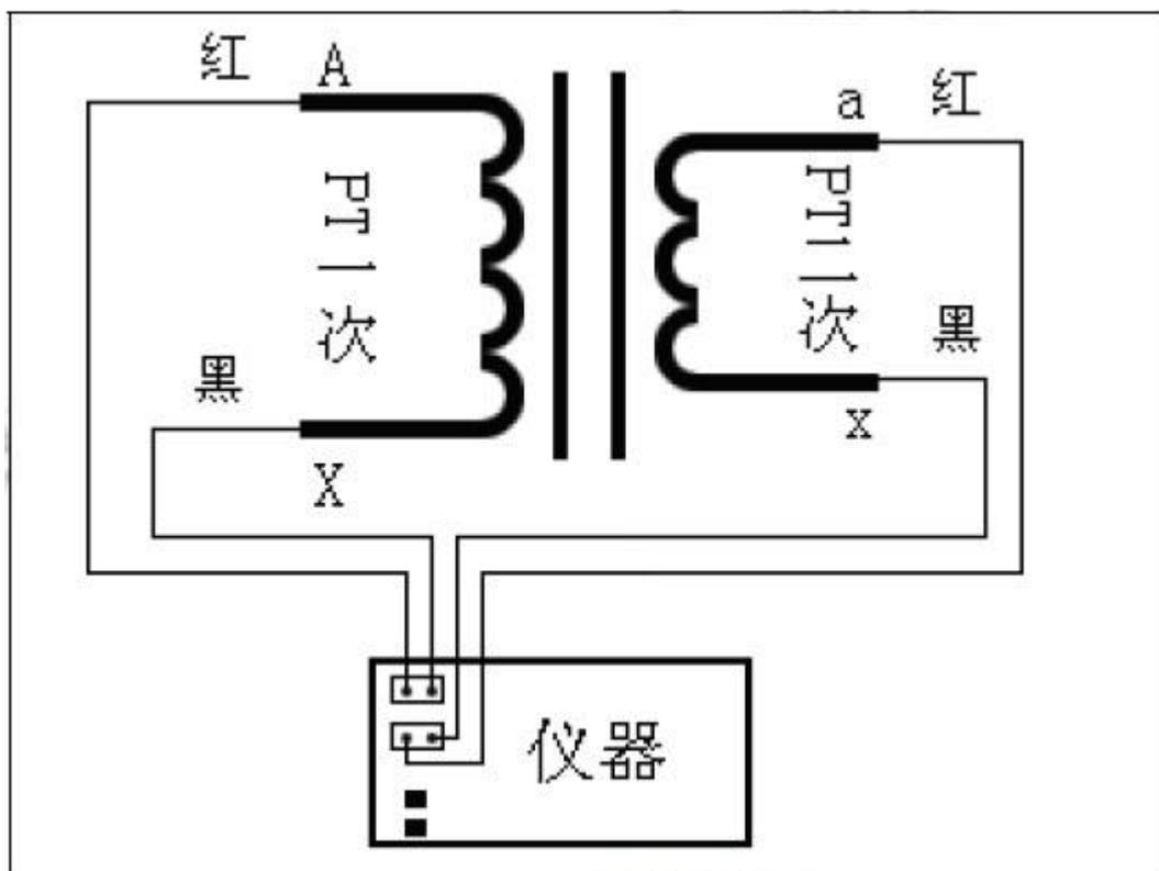
按“↑”、“↓”键，把光标移到“变比极性测量”上，按“确定”。进入变比、极性测量：
