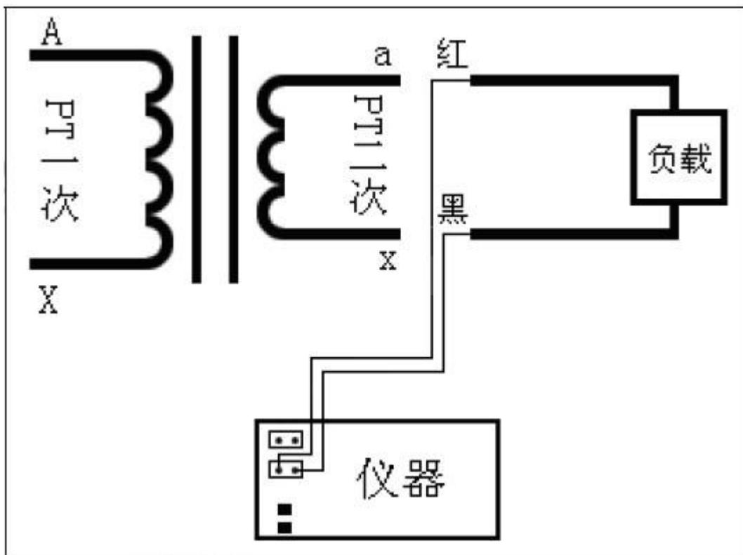
按“↑”、“↓”键，把光标移到“实际负荷测量”上，按“确定”。进入二次回路实际负荷测量：
