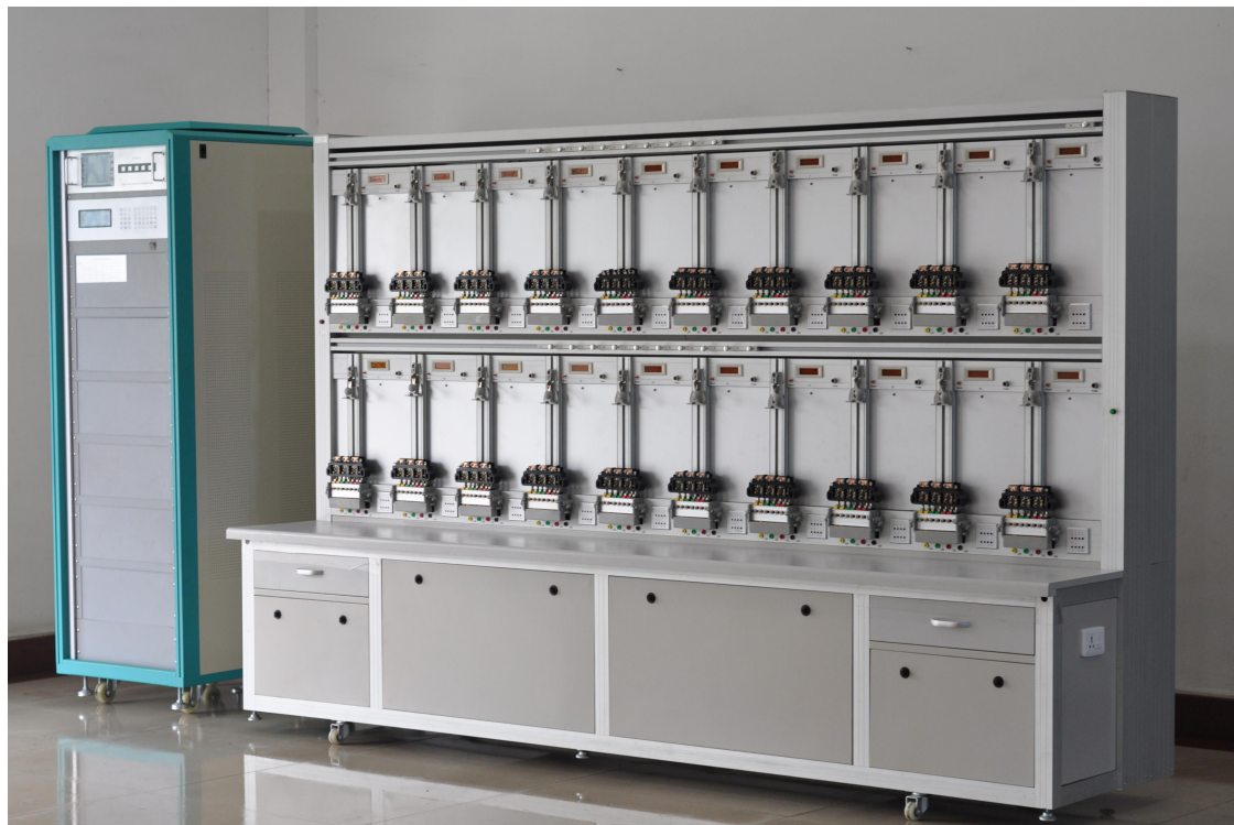
附图三：ZXDN-320 三相等电位校验装置（分体式）
