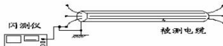
图（9）低压脉冲测试接线图
