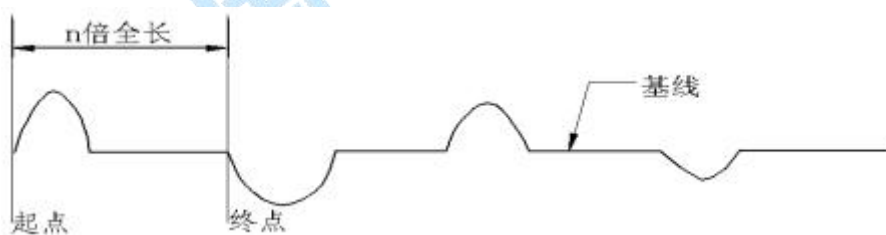
图（22） 近端故障冲闪测试波形
