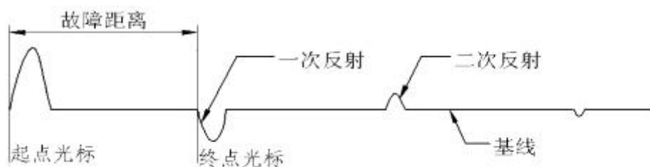
图（17） 低压脉冲测低阻短路故障波形
