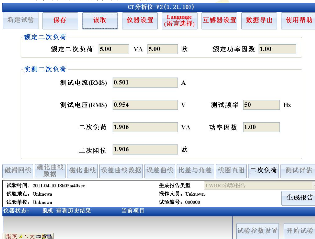
图 5.10 二次负荷测量试验结果
