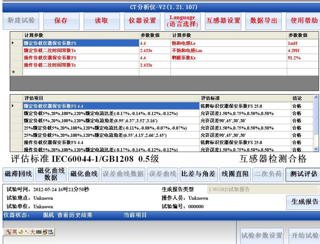
图 5.7 励磁参数和测试评估界面
