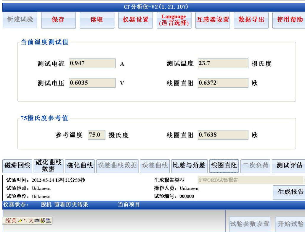
图 5.6 线圈电阻实测参数界面
