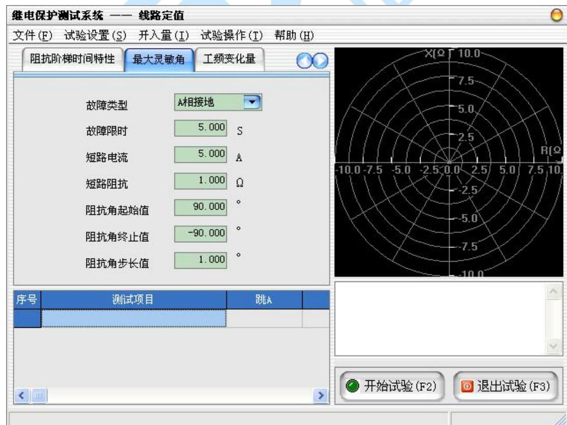
本试验用于测试线路的动作边界和最大灵敏角。各子项目的试验过程见“速
