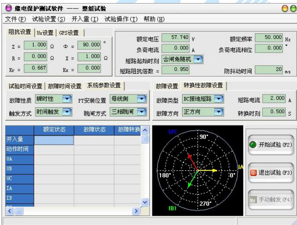
在将“故障设置”中的“转换性故障”选项打上了勾后，则可以进入“转换性故障设置”属性页中对转换性故障进行参数设置。
