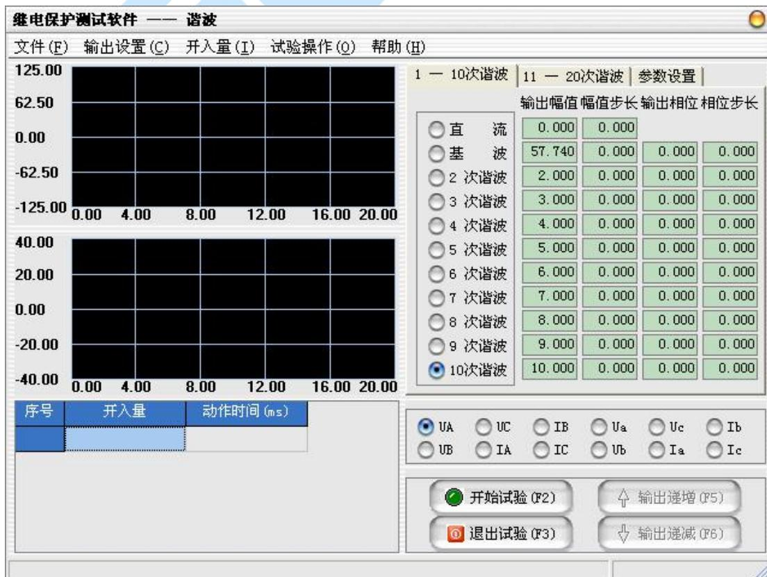
在中部的输入框中设置“输出幅值”、“幅值步长”、“输出相位”、“相位步长”，各电压、电流的各次谐波幅值在界面上以“伏特”或“安培”为单位显示其值，测试仪输出的值为界面上实际显示的电压电流大小。变量的变化步长应根据测试的要求选择合适的大小，一般地，步长越小，测试精度越高。
