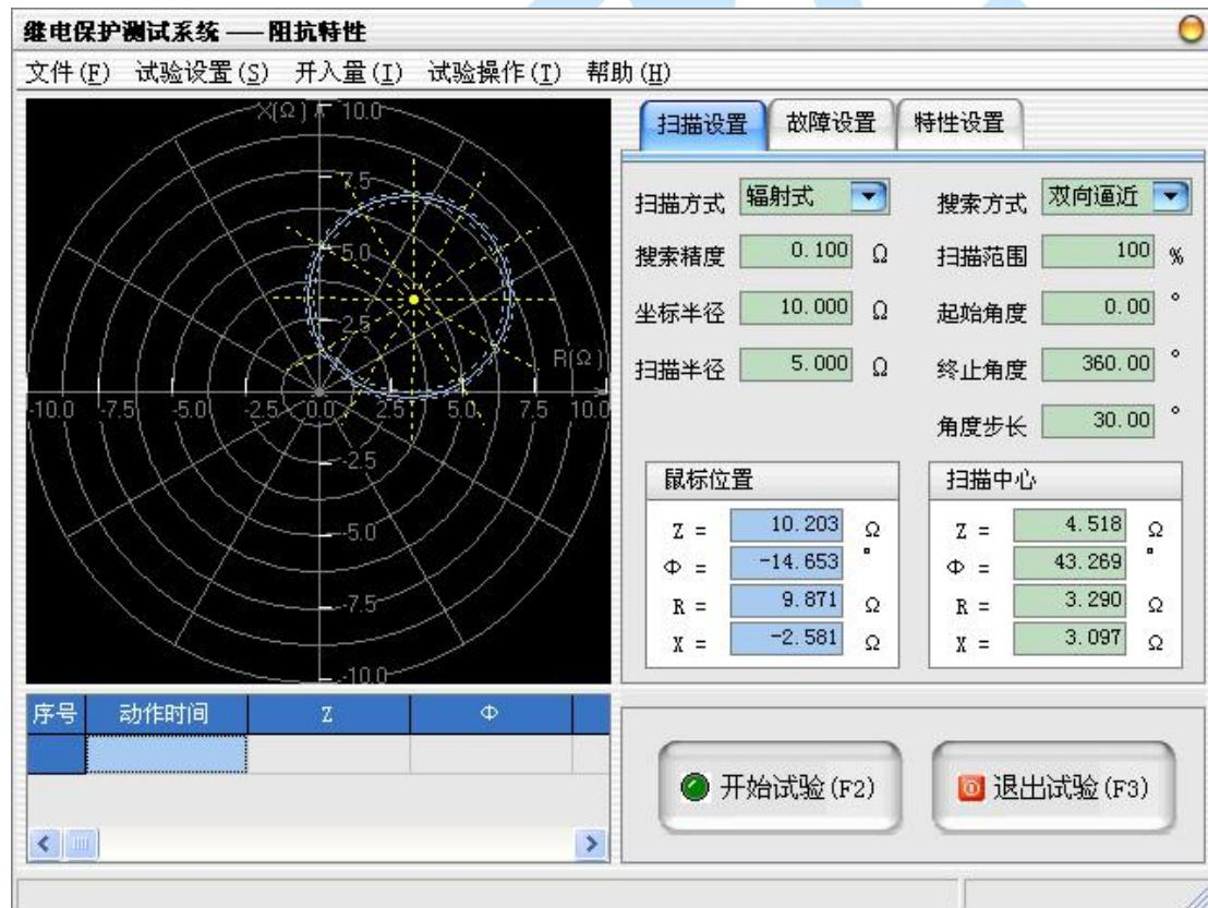
试验中待测试的扫描边界点由扫描角区域和步长决定，此处，扫描角度以平行于R轴为 $0^\circ$ 。例：取扫描角区域为 $0^\circ$ 到 $360^\circ$ ，步长为 $30^\circ$ ，则程序自动以 $0^\circ$ 为起点，以 $360^\circ$ 为终点，按逆时针方向，每隔 $30^\circ$ 计算一条扫描线。各扫描线的起点均为中心阻抗Z，长度由扫描半径决定，每条扫描线与整定边界特性的交叉点即为测试时等待搜索的动作边界点。
