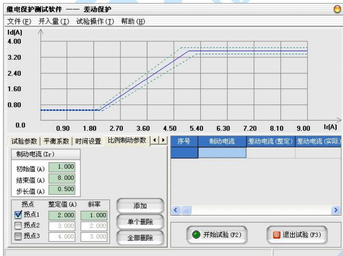
在“比例制动参数”属性页中设置比例制动特性的拐点和试验要测试的制动
