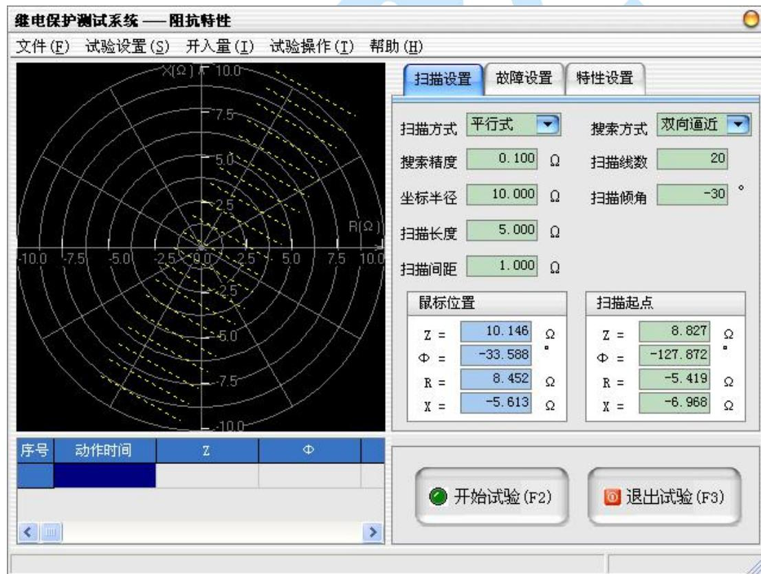
试验中待测试的扫描边界点由起点阻抗Z、扫描线倾角、间距以及扫描线数目决定，同理，此处扫描线倾角以平行于R轴为 $0^\circ$ 。设置完以上参数后，程序自动以起点阻抗Z为开始，沿R轴正方向，按“扫描间距”等距离地计算各扫描线，扫描线的方向平行于“扫描倾角”方向，扫描线的长短由“扫描长度”确定。每条扫描线与整定边界特性的交叉点即为测试时等待搜索的动作边界点。
