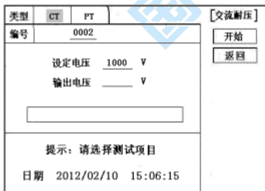
图 20 CT 交流耐压测试界面
