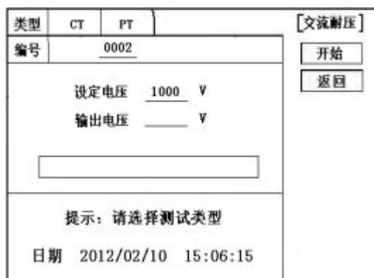
图 34 PT 交流耐压测试界面
