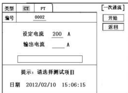
图 18 CT 一次通流测试界面
