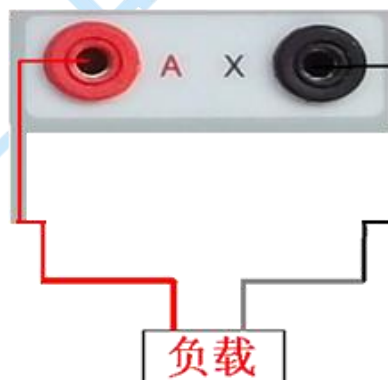
图 37 CT 二次负荷接线图
