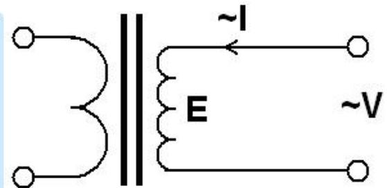
由此可见需要使 CT 进入相同饱和程度，施加较低频率信号所需电压可以大幅度降低这就是变频法的基本原理。
