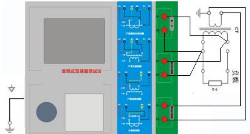
图 1 CT 直阻、励磁、变比试验接线方式
