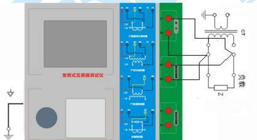
图 2 CT 二次负荷试验接线方式
