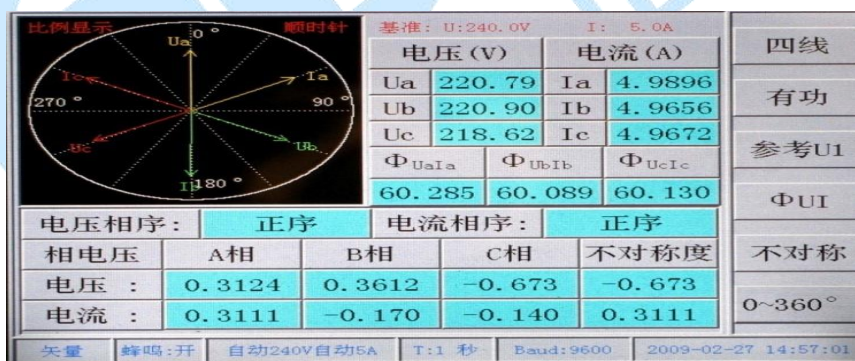
图 21 三相四线相位、相电压、电流不对称测量界面
