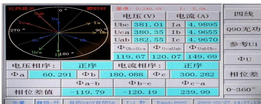
图 25 三相四线相位、线电压相位差测量界面
