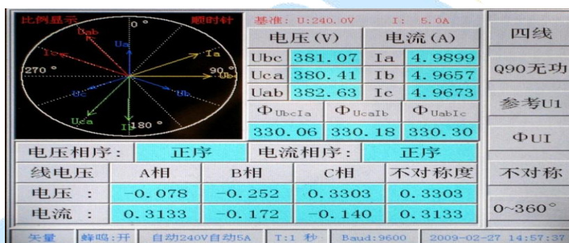
图 24 三相四线相位、线电压、电流不对称度测量界面
