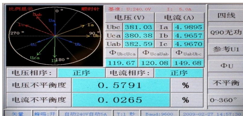
图 23 三相四线相位、线电压不平衡测量界面
