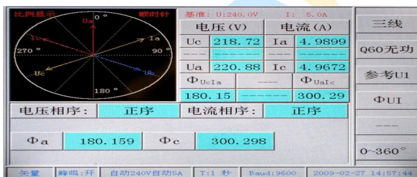
图 27 三相三线 Q60 方式下相位测量界面
