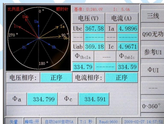
图 28 三相三线 Q90 方式下相位测量界面
