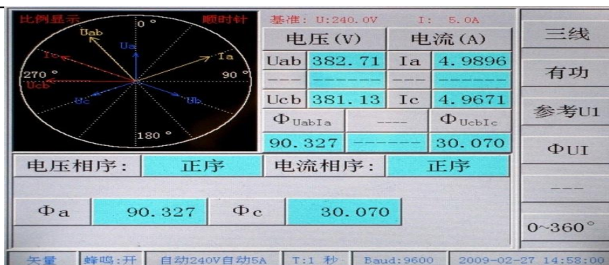
图 26 三相三线有功方式下相位测量界面
