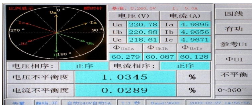
图 20 三相四线相位、相电压不平衡测量界面
