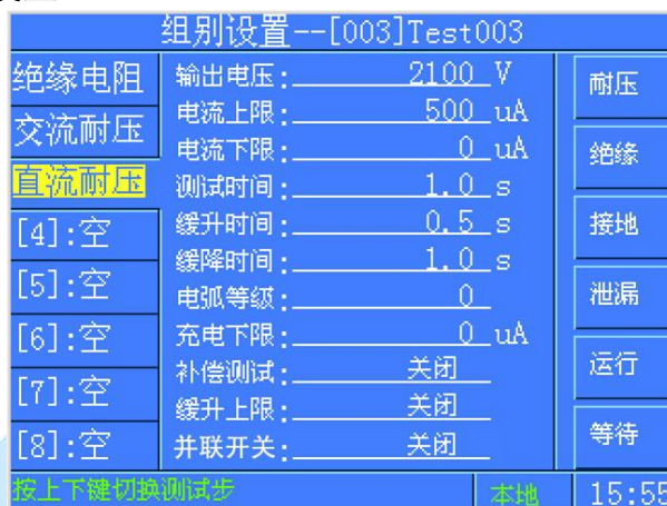
图 3-2-7-4 直流耐压设置界面
