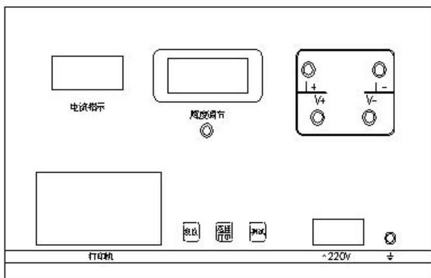
1.  $\sim$ 220V：整机电源输入口，带有交流插座，保险和开关。
