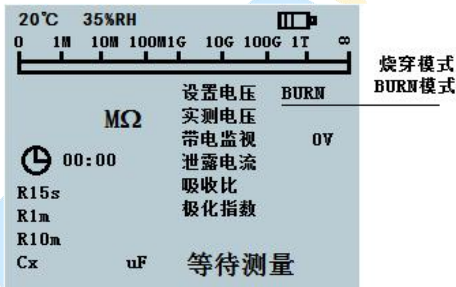
图 6-3（BURN 烧穿模式测试）
