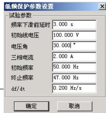
时”，可以使低频保护解除闭锁状态，然后才开始下滑频率。该时间参数就是用于保护解除频率闭锁。
