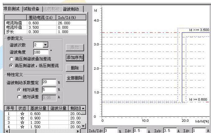
$I_{xb}/I_{de}$ : 3 %  $I_d$ : 0.5 A  $I_{xb}$ : 3.5 A  $I_{de}$ : 1 A
