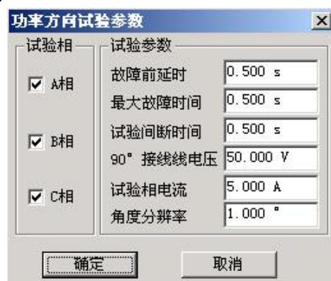
最大灵敏角是 $-45^\circ$ ，无论试验人员输入 $-45^\circ$ 还是 $+45^\circ$ ，都不会影响正常的试验。参数设置对话框如右图所示。
