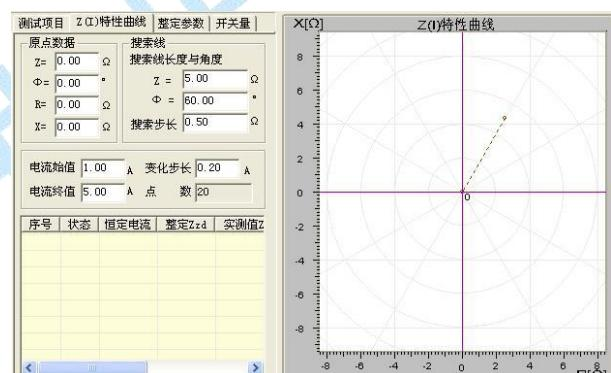
本试验的方法过程很像做差动继电器试验。如果把这里的阻抗比做差动试验的“制动电流”，则这里的电流就相当于“动作电流”。试验时，阻抗初始值为0，按一定的搜索步长增加。测试在每一个阻抗值下，保护的动作电流。测试完毕，软件会自动绘制出相应的曲线。“Z(V)特性曲线”参照“Z(I)特性曲线”。
