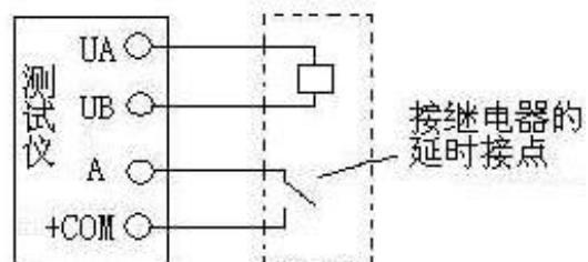
选择“手动”试验方式。开始输出一定时间后，就能测试出其动作时间。
