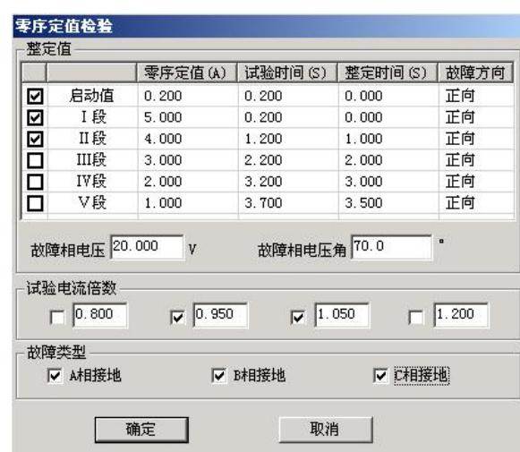
“启动值”栏用于测试保护的启动电流。保护是否启动往往可以从保护的启动指示灯上观察到。也常常用来替代 I 段，从而由“启动值”、“I 段”、“II 段”一起构成保护的 I、II、III 三段。
