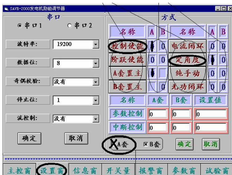
图6 南瑞电控 SAVR2000 励磁调节器开环测试设置画面
